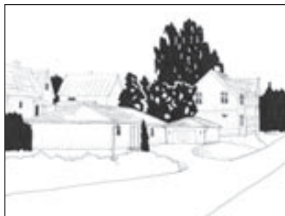
Eksempel på hvordan nytt hus ikke forholder seg til de eksisterende omgivelsene. Brudd med volum, høyde og takform.
