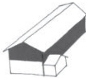
Uheldig løsning. Tilbygget mangler sammenheng til den eksisterende bygningen.
